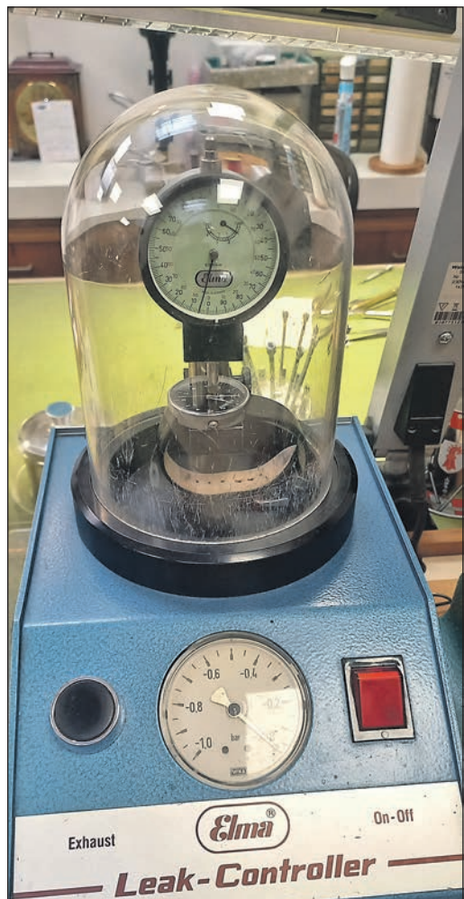
Der Leak-Controller checkt mit Luft, ob ein Uhrengewand wasserdicht ist. Foto: js
