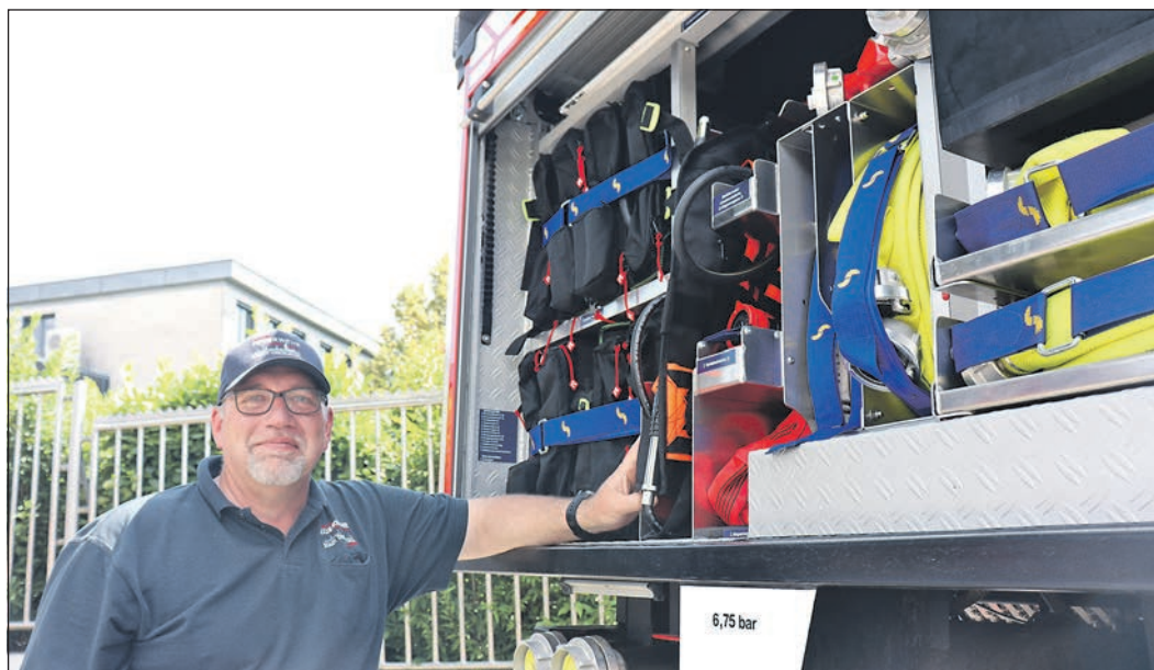
Alexander Wehrheim erklärt die Ausrüstung des Fahrzeugs mit (v. l.) Waldbrandrucksäcken, Löschrucksäcken, gelben D-Schläuchen und – darauf liegend – C-D-C-D-Verteiler. Foto: gt
