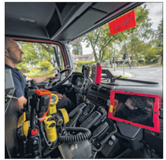
Rote Leuchtdioden und das Kamerabild warnen vor einer Person im Toten Winkel.
